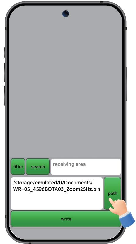
4. 打开无线遥控器。在手机App内点击“search”选择对应需要升级到的无线设备，并进行配对。完成连接后，点击“write”即可开始更新，写入过程中将显示更新进度，且手柄绿色灯长亮。
